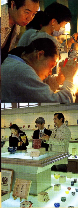
カットの模様に合わせてダイヤモンドホイールで水を流しながら削り込む作業。繊細な動きに田崎も息をのむ 島津公保社長に説明していただく。ちよつと見にくいけど、台の上にある藍色がワワサの「船形鉢」。手前の金赤 三段重 は三八万円
